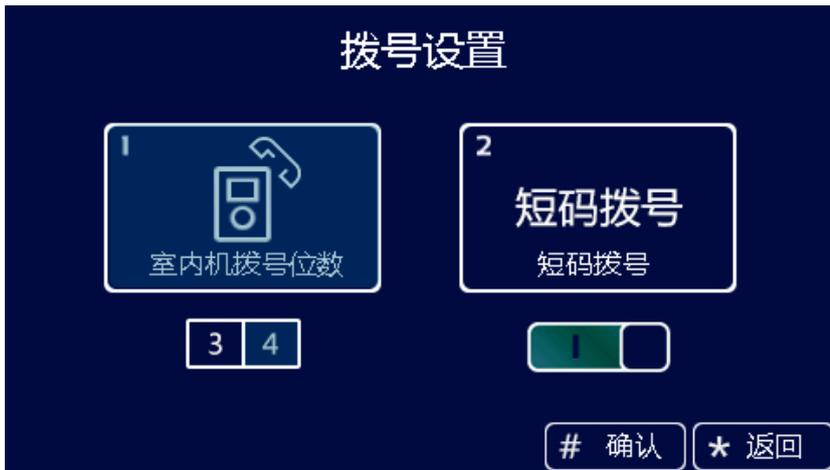
当设备类型为围墙机时，拨号设置界面如下。单元拨号位数可选择 1、2、3 位，室内机拨号位数可选择 3、4 位。相关配置呼叫可参照围墙机拨号规则表。
