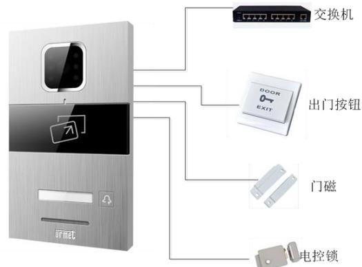
RJ45 网络接口：连接线接口，可连接 24V 非标 PoE 交换机；
